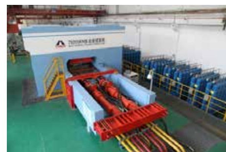
Figura 7. Máquina de test para dispositivos sísmicos propiedad de HIRUN, Wuhan (China).
