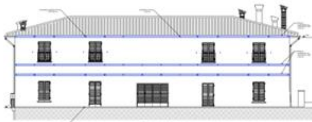
Figura 3. Prospetto frontale con aggiunta di fasce CFRP alla quota della fascia di piano terra.
