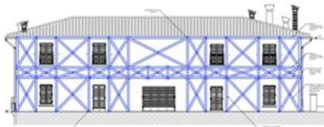
Figura 5. Prospetto frontale con aggiunta di fasce CFRP disposte a Croce di Sant'Andrea.
