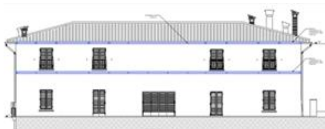
Figura 2. Prospetto frontale con fasce CFRP alla quota dei solai e della copertura.
