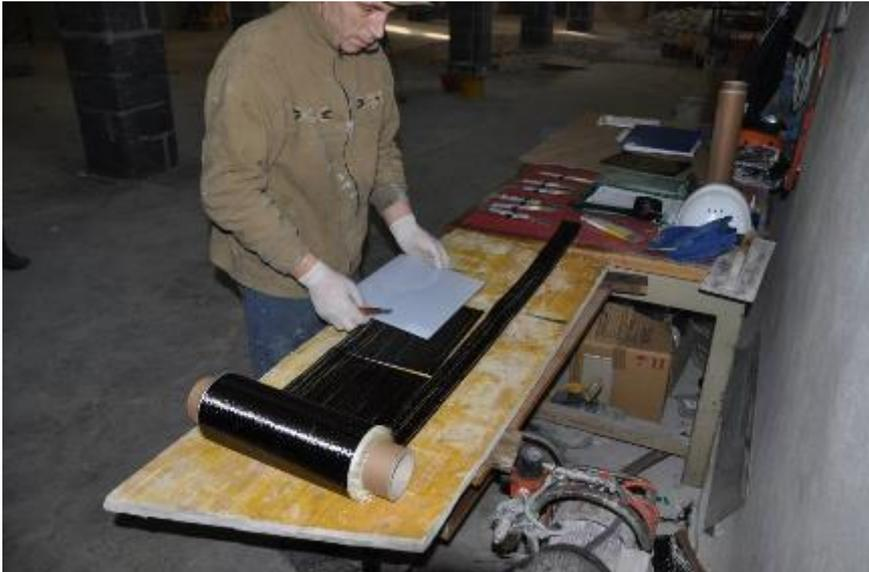
**PRELIEVO CAMPIONE DI TESSUTO SECCO PER PESATURA E PER LA REALIZZAZIONE DEL PACCHETTO DI LAMINATO SU TAVOLETTA DI LAMINAZIONE**
