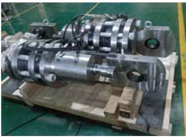
Figura 4. Dissipatore HIFLUID VSD
