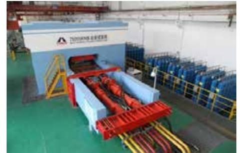
Figura 7 Macchina di test dei dispositivi sismici di proprietà HIRUN, Wuhan (Cina).
