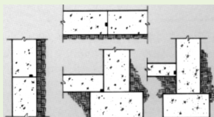
Posizionamento del SUPERSTOP in differenti giunti di ripresa di getto del calcestruzzo.
