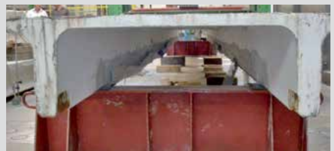
Fig. 6 Test a rottura trave in c.a.p. rinforzata.
