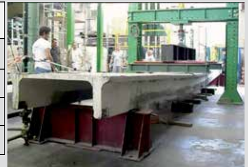
Fig. 4 prova di carico della trave in c.a.p. rinforzata con malta Concrete Rock V2 e tessuto in acciaio STEEL NET 190.
