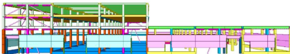
Figura 3. Modello F.E.M. del fabbricato industriale
