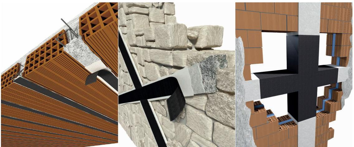
*Il sistema Betontex viene comunemente usato per: confinamento di pilastri e nodi trave-pilastro, rinforzo di murature di varia tipologia e solai, anche per mezzo di lamine*
