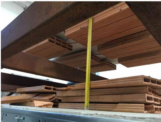
*Il campione dopo l’impatto con il controsoffitto e il termine della prova*
