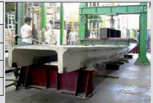
Fig. 4 Prueba de carga de la viga de hormigón pretensado, reforzada con mortero CONCRETE ROCK W y tejido de acero STEEL NET 190.
