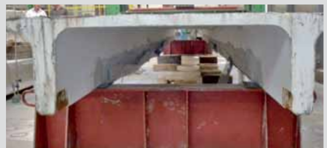
Fig. 6 Test de rotura en viga de hormigón pretensado reforzada.
